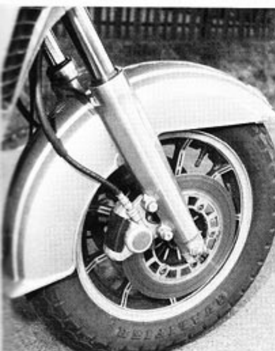
— 16-tums framhjul — med däckdimension 130/90! — stadig framgaffel med extra gaffelbrygga och dubbla bromsskivor med dubbelkalvsok.
