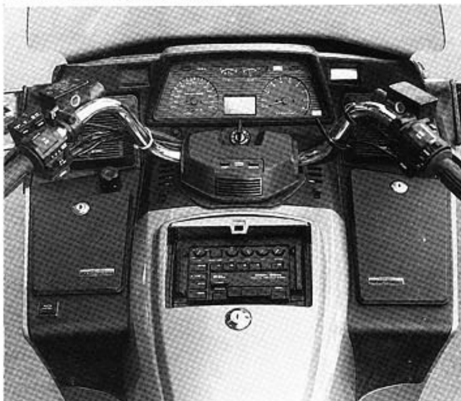
— Här finns det grejor: vid vänster handtag har man, förutom kopplingshandtag, helljusomkopplare, signalhornsknapp och blinkersreglage — med automatisk återgång — också manöverdon för radion. I det lilla fönstret snett till höger om varvräknaren ser man stationsinställningen. Till höger finns, förutom gas, handbroms, nödstopp och startknapp, reglagen för "autopiloten". När den är inkopplad lyser en kontrollampa längst ner till vänster på mätarpanelen. Nedanför tändningsnyckeln sitter knappar för digitalklockan. Tiden visas i fönstret ovanför nyckeln. Där syns också vilken växel som är ilagd. Om något fel uppstår, till exempel trasigt bakljus, ser man istället en symbol på samma display.
